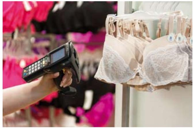
Implantación de la tecnología de Checkpoint Systems en las tiendas de C&A: lector de RFID con el software de OAT's para el conteo cíclico de productos.
