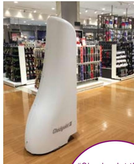
Prototipo de robot de RFID implantado en una tienda de AEON, que automatiza el conteo de productos, mejorando la visibilidad de inventario y la experiencia de compra del consumidor.
