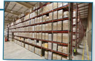
paralelos a los estantes. Con este sistema, en la zona de logística del nuevo almacén se obtiene una capacidad para 15.000 paletas instaladas en una altura de 11,40 metros.
